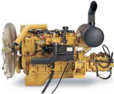
**Эксплуатационные характеристики.** Двигатель Cat C7 с технологией ACERT™ развивает более высокую мощность, чем предшествующие модели. Он работает на более низких оборотах, за счет чего повышается топливная экономичность и увеличивается ресурс узлов и деталей. На экскаватор 329D устанавливают один из двух двигателей, отличающихся по мощности:
