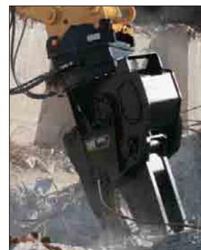
**Рыхлитель.** Рыхлитель Caterpillar серии TR позволяет прикладывать мощное точечное усилие внедрения, необходимое для разрушения скалистого грунта или других твердых материалов.
