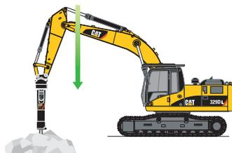
**Работа гидравлическим молотом.** При разработке горной породы стрела свободно перемещается за молотом. Благодаря этому удастся избежать ударов вхолостую и перегрузки молота, это увеличивает срок службы молота и машины. Аналогичные преимущества стрела SmartBoom имеет и при работе с виброплитами для уплотнения.
