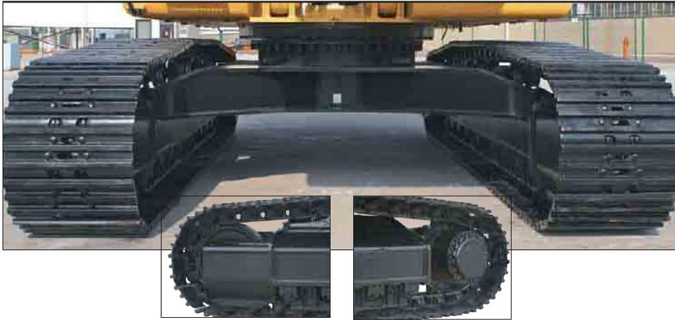
**Сварка роботизированным оборудованием.** Более 95% сварных соединений в экскаваторах Caterpillar выполняется сварочными роботами, позволяющими более чем в три раза увеличить глубину провара по сравнению с ручной сваркой.
