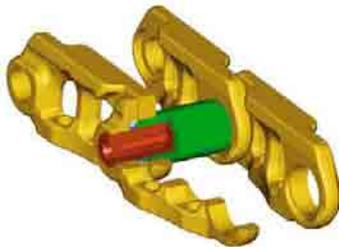
**Гусеничные ленты.** В стандартной комплектации узлы "палец-втулка" гусеничной ленты экскаваторов 329D герметизированы и смазаны консистентной смазкой. Гусеничная лента состоит из герметизированных не нуждающихся в смазке узлов "палец-втулка", за счет чего уменьшается износ пальцев и втулок, снижается уровень шума при движении, увеличивается срок эксплуатации гусеничной ленты. Таким образом, сокращаются эксплуатационные расходы.
