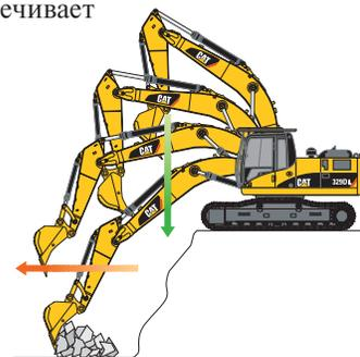
**Загрузка самосвалов.** Повышена производительность и топливная экономичность при загрузке самосвалов с возвышения. Время цикла возврата уменьшено, а при опускании стрелы не потребляется мощность гидронасоса.
