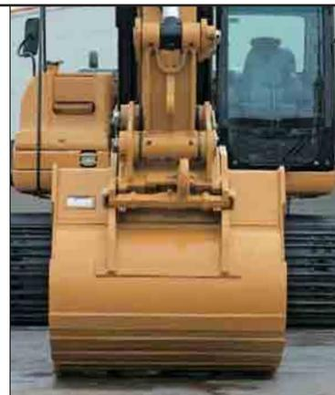
**Рычажный механизм навески ковша.** Экскаватор может оснащаться рычажными механизмами навески ковша двух типов (CB2 и DB). Напорные рычаги механизмов имеют подъемную проушину.
